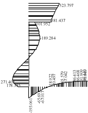
Obr. 27. Schéma průběhu normálových napětí \sigma_x a \sigma_y v příčném řezu (oblouk) – varianty „a“, „b“, „c“
