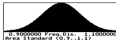
Obr. 2. Histogram AREA-S slouží k vyjádření rozptylu plochy průřezu
