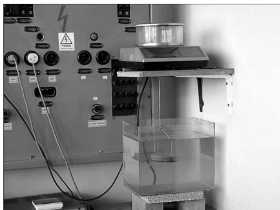
Obr. 3. Experimentální uspořádání pro měření Archimédovy hmotnosti
