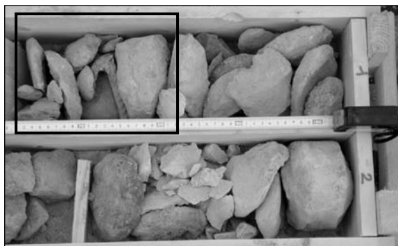
Obr. 7. Vrt VJ-11. Makroskopický vzhled železobetonové desky
