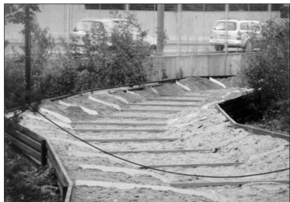
Obr. 7. Polní model dolního Labe (osazené příčné profily a štěrkopísková výplň)
