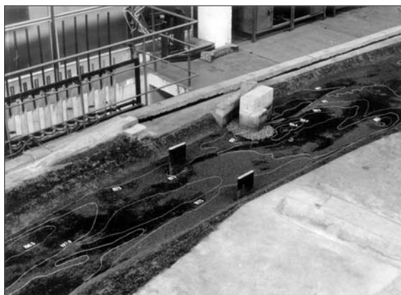
Obr. 1. Model říčního úseku Labe s pohyblivým dnem budovaný klasickou technologií
