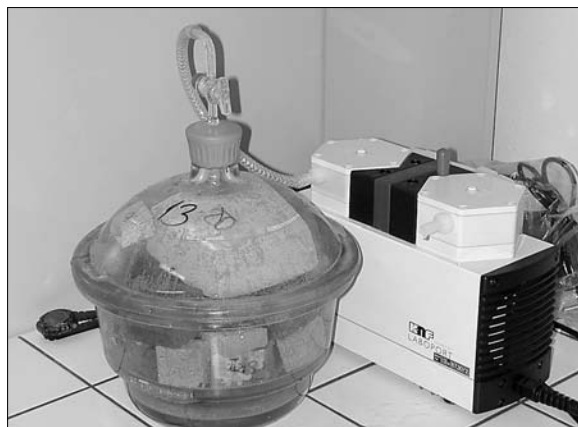
Obr. 2. Experimentální uspořádání pro měření vakuové nasákavosti
