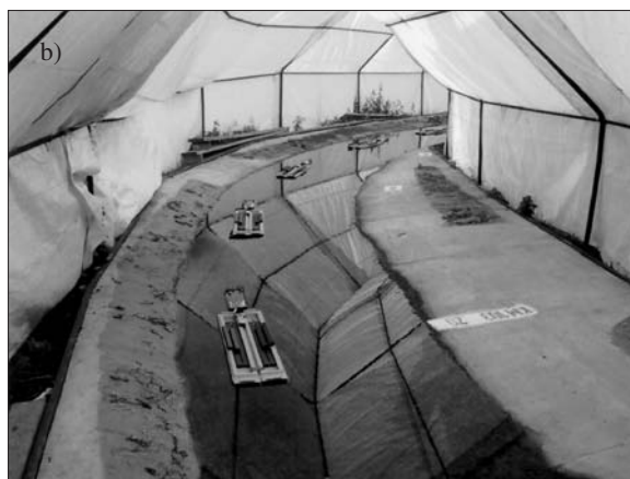
Obr. 9. Časově rozložený pohyb tlačného soulodí (provizorně zastřešený polní model dolního Labe)
