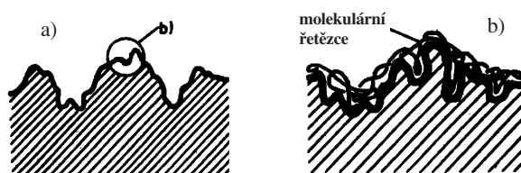
Obr. 12. Struktura povrchu pevných látek a – makrostruktura, b – mikrostruktura
