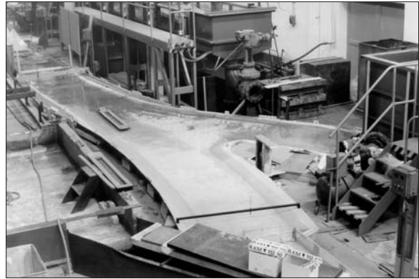
Obr. 6. Model odbočení plavebního kanálu z Labe (kovová sekce kanálu a maltovinová část řeky)
