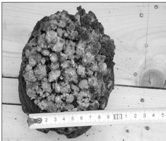
Obr. 5. Makroskopicky pozorovatelné výkvěty solí na keramzitbetonu
