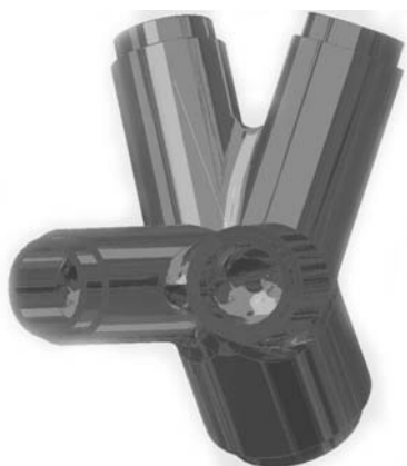
Obr. 14. Výpočetní model prostorového styčnicku
