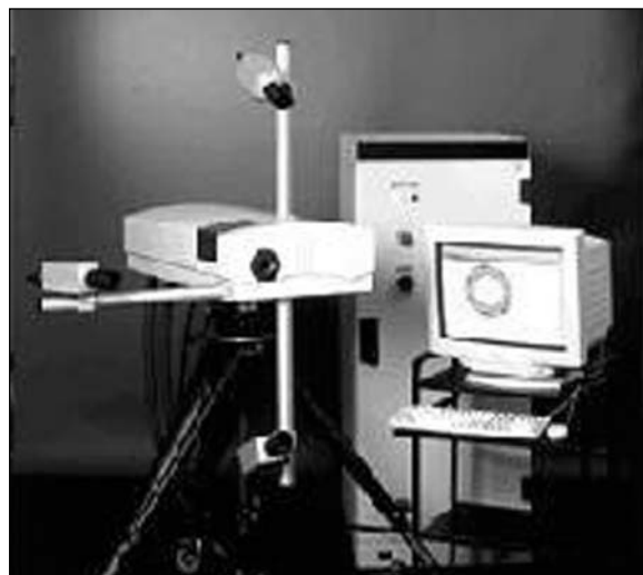
Obr. 8. Systém pro měření vibrací využitím digitální speklinterferometrie
