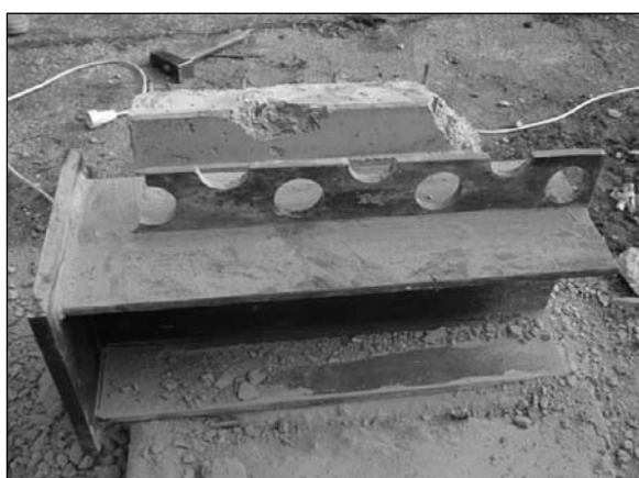
Obr. 6. Vzorek B3/1 po zkoušce (vlevo je vidět odlomený okraj lišty)
