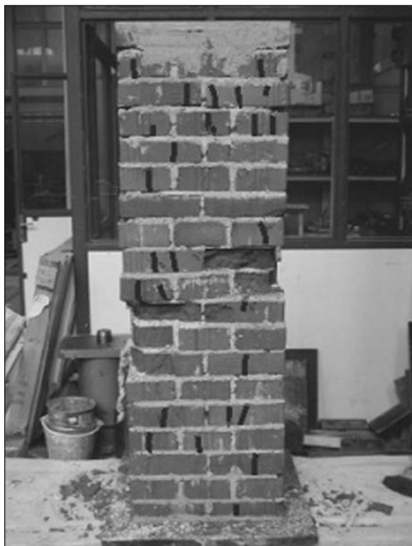
Obr. 2. Porušení tlačného zděného pilíře po dosažení mezního zatížení
