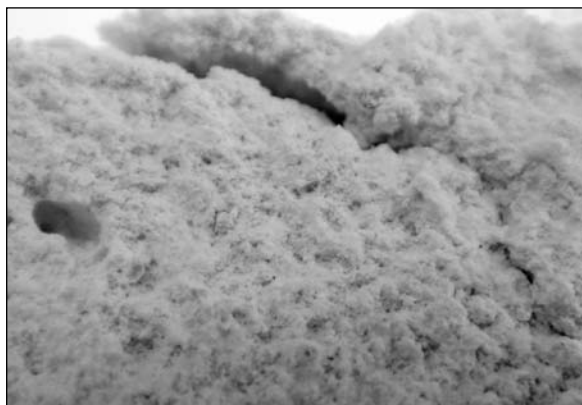
Obr. 5. Povrch omítky rozpraskaný ve tvaru mezikruží
