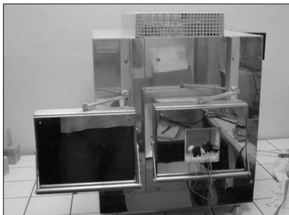
Obr. 1. Pec pro měření součinitele teplotní vodivosti
