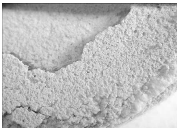
Obr. 4. Schéma zóny krystalizace a následného porušení struktury omítky
