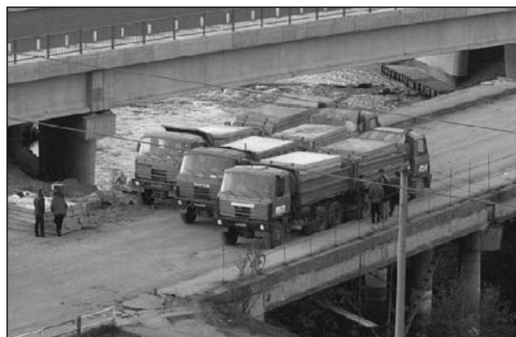
Obr. 3. Tri dvojice ťažkých nákladných vozidiel na moste – zaťažovací stav C
