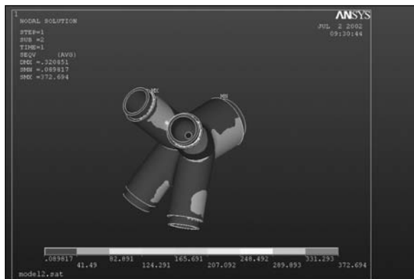
Obr. 15. Napjatost ve styčnicku
