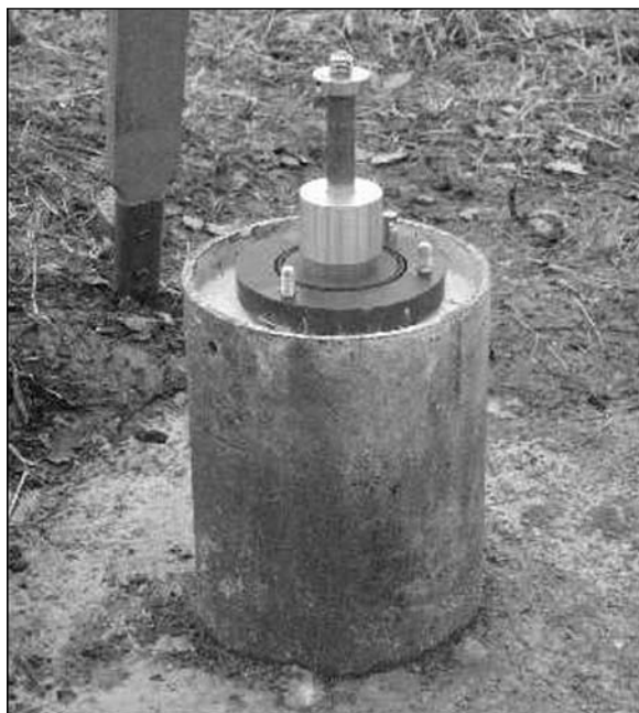
Obr. 3. Referenční bod s vloženým středícím trnem a stativ přístroje Leica TC 1800
