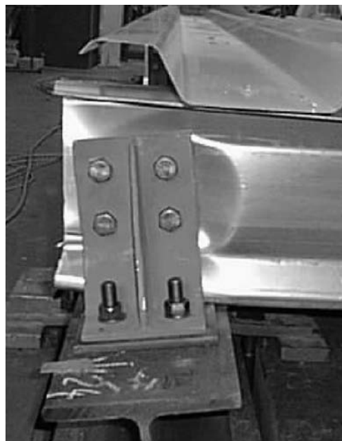
Obr. 8. Kolaps vaznice v testu C
