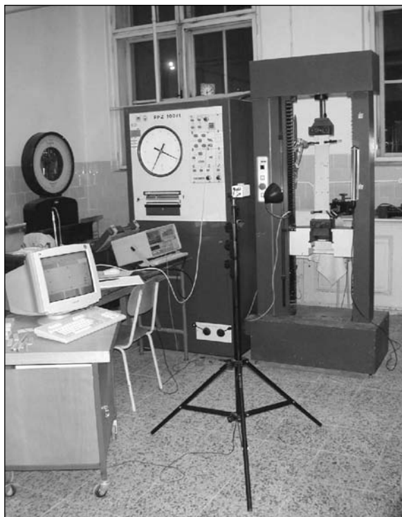
Obr. 2. Osazení zkušebního tělesa do lisu a příprava snímacího zařízení k vyhodnocení zkoušky
