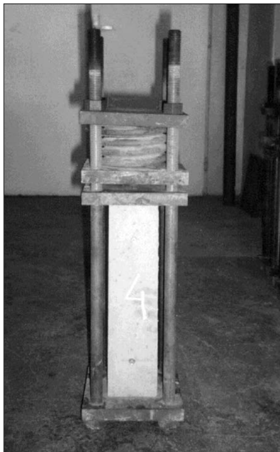
Obr. 2. Oceľová klietka s vloženým hranolom na meranie dotvarovania betónu
