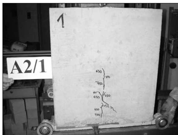
Obr. 10. Tvar trhlin při experimentu
