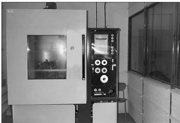
Obr. 1. Pohľad na spôsob merania vzoriek a klimatizačnú komoru Feutron
