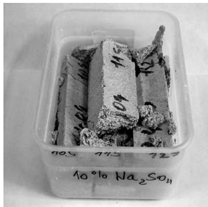
Obr. 9. Vápenná omítka den po vložení do roztoku síranu sodného
