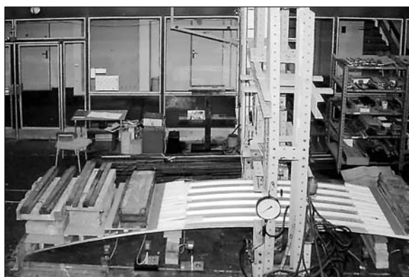
Obr. 4. Zatížení představující hromadění betonu u podpor
