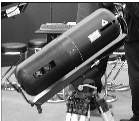
Obr. 8. Panoramatický skener se základnou s dosahem D2 a přesností P2 (MENSI)
