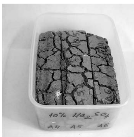
Obr. 10. Vápenná omítka s mletým cihelným střepeu z Dolních Jirčan po 28 dnech po vložení do roztoku síranu sodného
