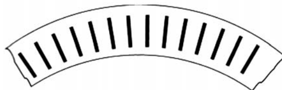
Obr. 8. Principy elektronického odečítání – přírůstkové s využitím jedné stopy
