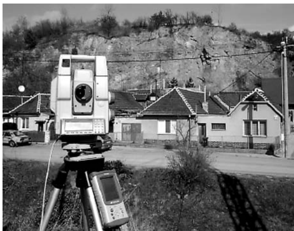
Obr. 14. Totální stanice Topcon GPT-8200 při skenování nepřístupné skalní stěny
