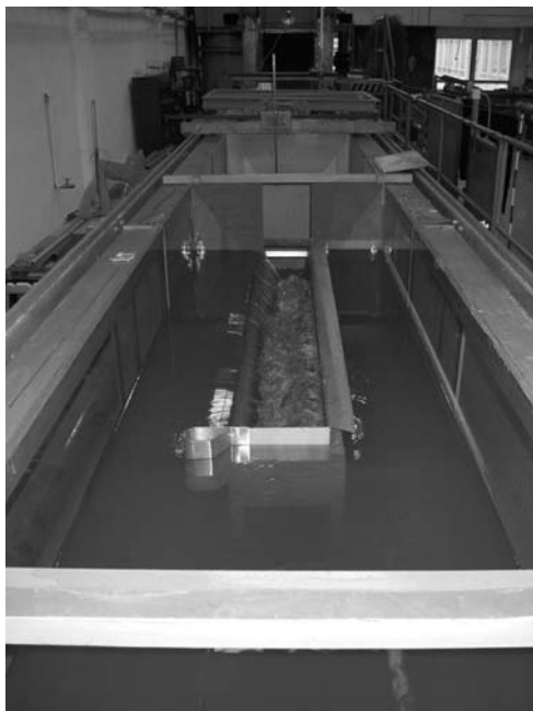
Obr. 2. Model jednostranného bočního přelivu se sklonem spadiště 6 % při průtoku 54 l/s
