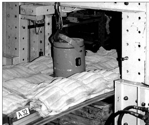
Obr. 5. Lokální zatížení vnesené kalibrováním válcem
