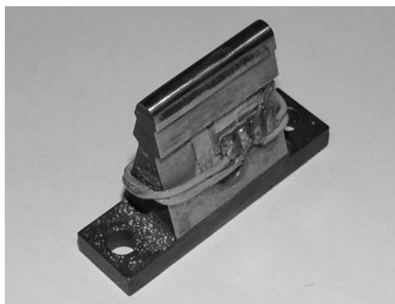
Obr. 2. Vystrojení břitu Charpyho kladiva tenzometry
