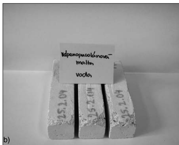
Obr. 6. Vápenná omítka – uložení voda a – po 1. zmrazovacím cyklu, b – s metakaolinem z Božičan po 40 zmrazovacích cyklech
