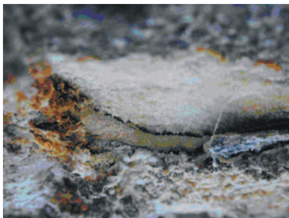
Obr. 18. Příklad deskovité exfoliace pískovce [cm] (foto P. Pospíšil)
