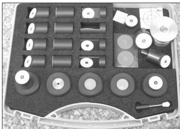
Obr. 5. Sada speciálních hranolů od firmy Leica
