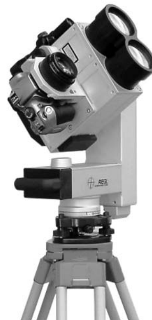
Obr. 10. Polární panoramatický skener LPM-800HA s dosahem D4 a přesností P4 (RIEGL)
