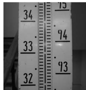
Obr. 6. Dřevěná nivelační lat' s invarovým páskem
