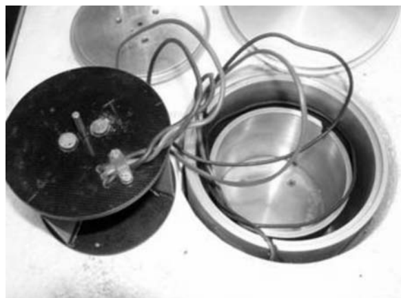
Obr. 3. Měřicí část vyjmutá z dvouplášťové nádoby kalorimetru. Dvě nádoby (patrně jsou pouze jejich zátky) mají na sobě diferenčně zapojené snímače tepelného toku ve tvaru křídélek pod úhlem 120^\circ .
