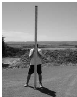
Obr. 6. Dřevěná nivelační lat' s invarovým páskem
