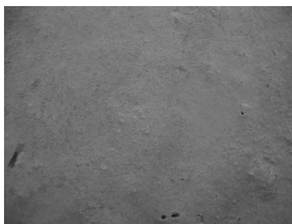
Obr. 4. Kompozit zatížený na 1000 °C
