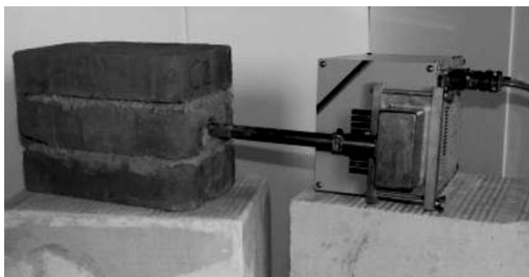
Obr. 2. Vysoušení pomocí zásuvné tyčové antény
