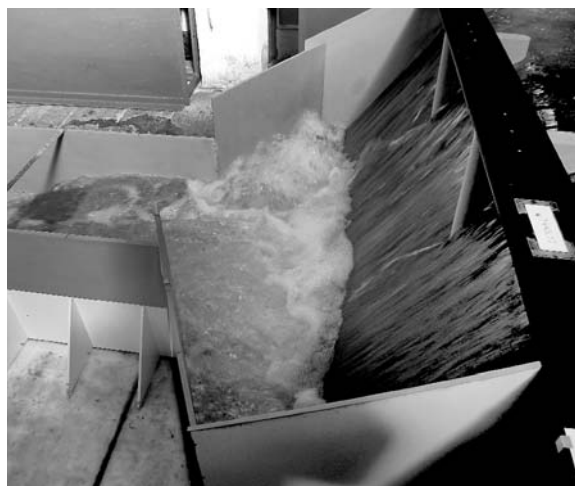
Obr. 3. Vyhodnocení varianty č. 9 při návrhovém průtoku Q_{1000}
