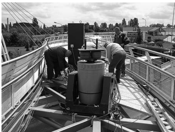
Obr. 10. Pohled na elektrodynamický budič TIRAVIB 5140 ukotvený na konstrukci lávky
