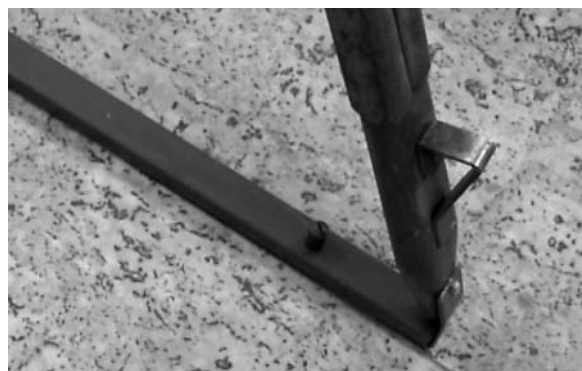
Obr. 4. Detail upevnění noh stativu
