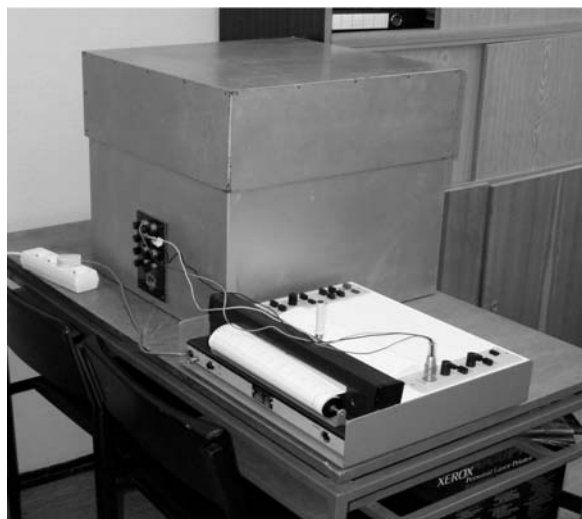
Obr. 2. Kalorimetr KC 01 se zapisovačem
