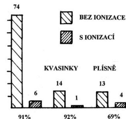
Obr. 8. Výsledek sterilizace vzduchu ionizací ve výrobně majonézy
