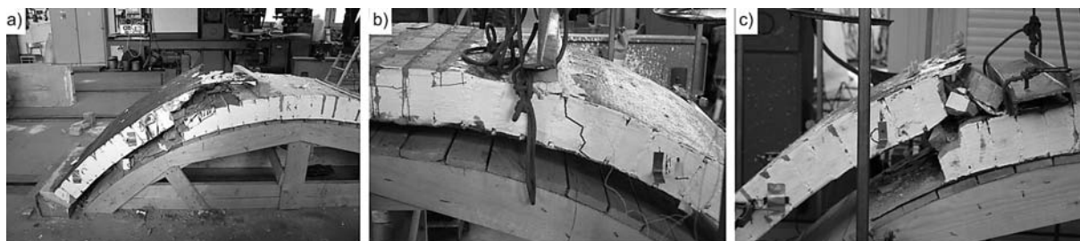
Obr. 13. Porušení smykem oboustranně zesílené klenby uhlíkovou tkaninou a), b) klenba K09, vzepětí 0,75 m; c) klenba K08, vzepětí 1 m
