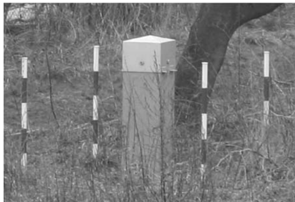
Obr. 4. Pilíř pro nucenou centraci v Radotíně
