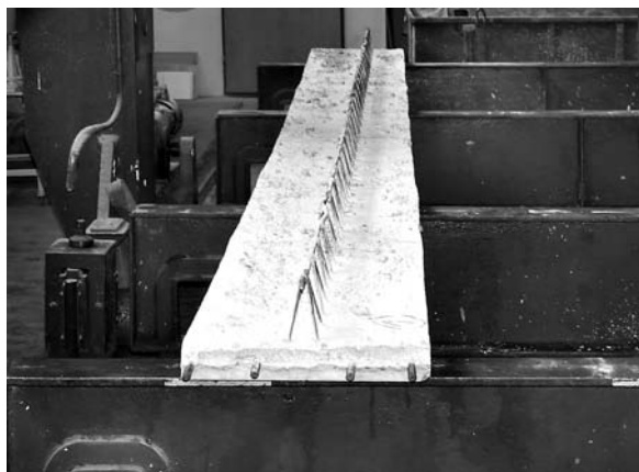
Obr. 15. Zkušební vzorek po odtížení (na fotografiích jsou patrné zbytkové deformace horního pásu)
