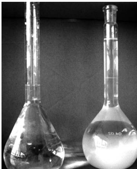
Obr. 3. Zakalení roztoku síranu hlinitého (vpravo) v porovnání se společným roztokem síranu hlinitého a kyseliny citrónové (vlevo)
