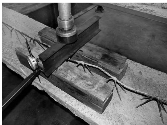
Obr. 13. Vybočení horního pásu příhradové výztuže v krajním poli 200 mm při zatížení 30 kN
