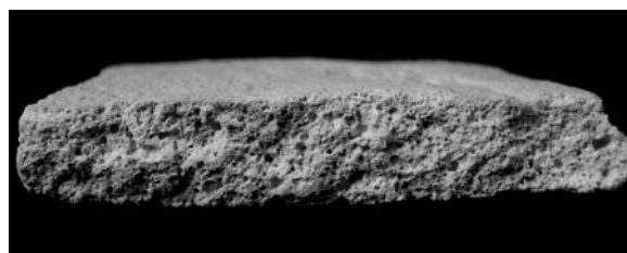
Obr. 7. Struktura sádrové pěnové hmoty s přísadou perlitu
