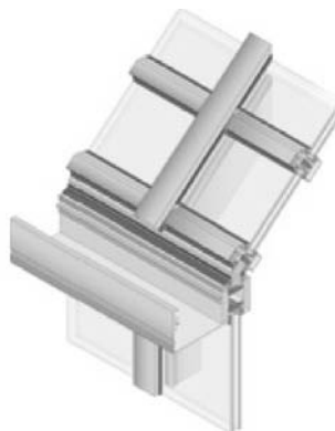
Obr. 7. Detail ukončení u žlabu prosklené střešní konstrukce
