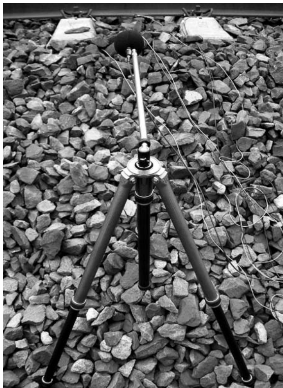
Obr. 2. Upevnění mikrofonu do trojnohého stativu – Vossloh W 14
