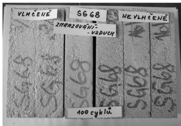
Obr. 5. Sanační vyrovnávací malta Baumit Bayosan SG 68 zmrazovaná při nulové vlhkosti vzduchu po 100 zmrazovacích cyklech
