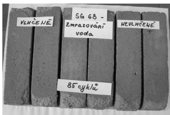
Obr. 4. Sanační vyrovnávací malta Baumit Bayosan SG 68 zmrazovaná ve vodou nasyceném stavu po 85 zmrazovacích cyklech
