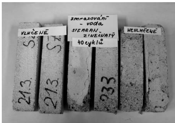
Obr. 6. Vápenná omítka s metakaolinem a stearamem zinečnatým po 40 zmrazovacích cyklech
