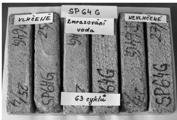
Obr. 6. Sanační omítka hrubá Baumit Bayosan SP 64 G zmrazovaná ve vodou nasyceném stavu po 63 zmrazovacích cyklech
