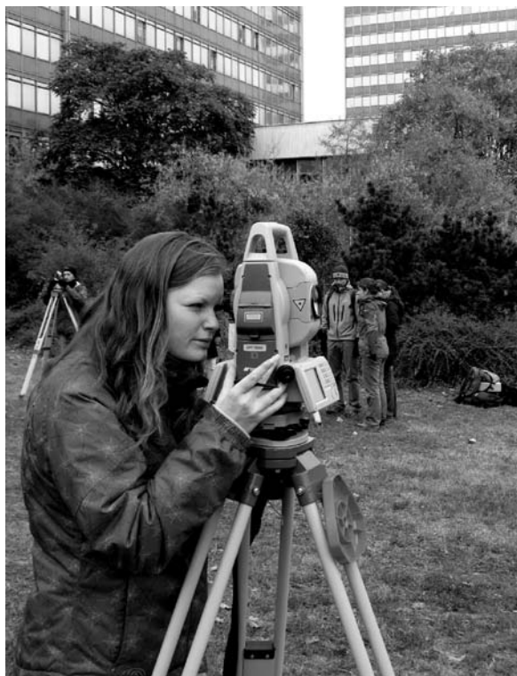
Obr. 1. Totální stanice Topcon GPT-7501 při výuce Inženýrské geodézie
