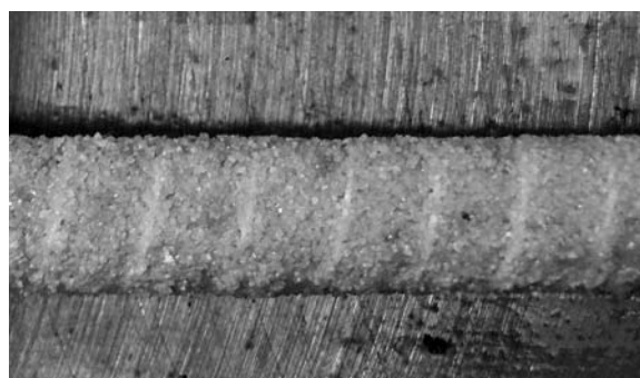
Obr. 1. Povrchová úprava použitých prutů GFRP
