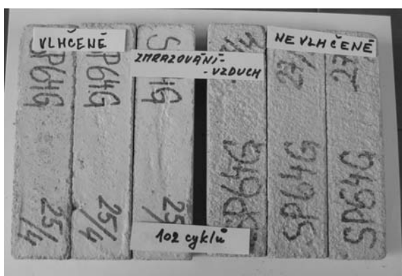
Obr. 7. Sanační omítka hrubá Baumit Bayosan SP 64 G zmrazovaná při nulové vlhkosti vzduchu po 102 zmrazovacích cyklech
