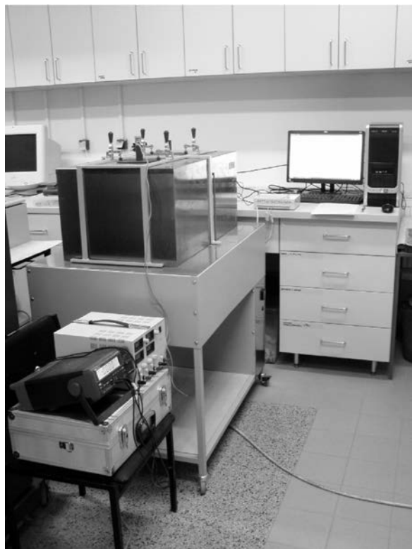
Obr. 2. Kalorimetr připojený na ústřednu a počítač
