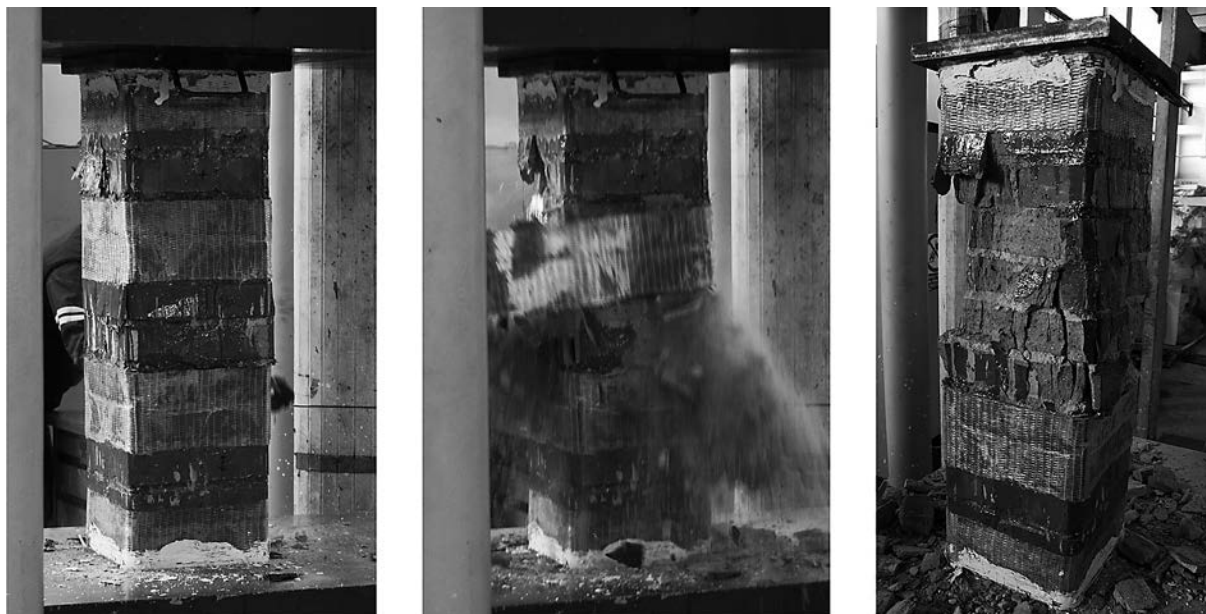
Obr. 8. Porušení zesíleného zděného pilíře pásy tkaniny se skleněnými vlákny při dosažení mezního zatížení
