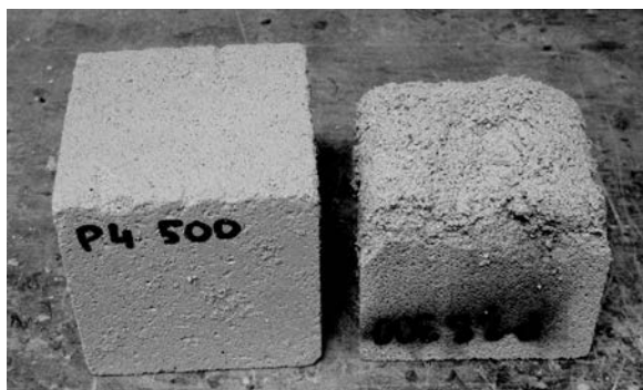
Obr. 3. Vzorky po 50 zmrazovacích cyklech
