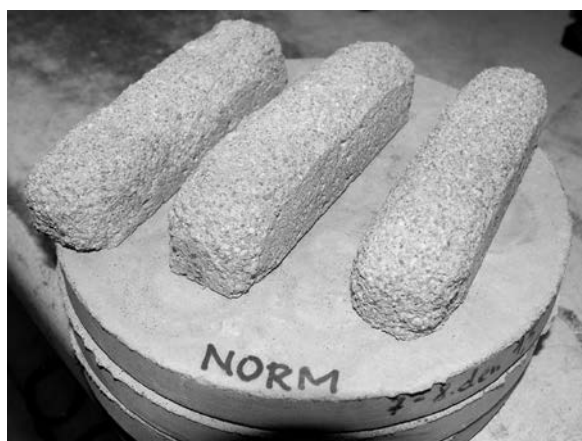
Obr. 9. Vzorky cementové malty bez přídavku hydrofobizéru po 50 cyklech zkouškou CHRL
