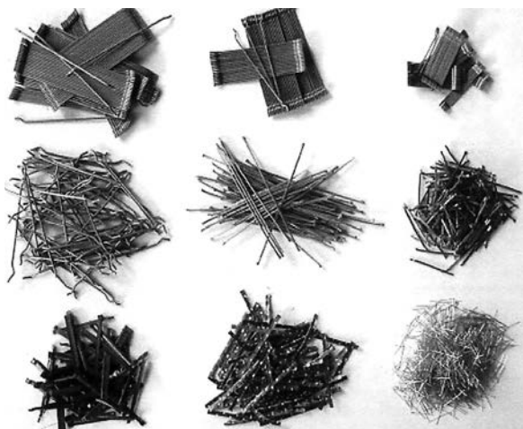
Obr. 4. Typy vláken užívaných do vláknobetonu
