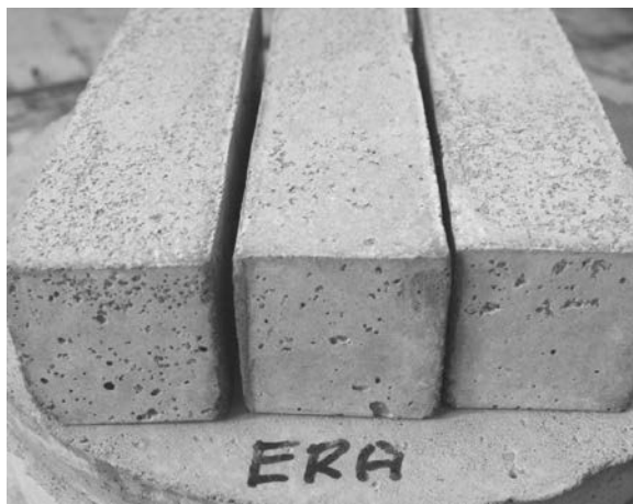
Obr. 10. Vzorky cementové malty s obsahem silikonového hydrofobizéru ERA po 50 cyklech zkouškou CHRL
