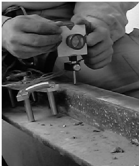
Obr. 6. Odrazný hranol s hrotem
