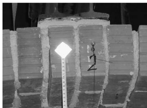
Obr. 10. Porovnání matematického modelu s experimenty (klenba zesílená dvěma drážkami zatížená ve čtvrtině rozpětí)
