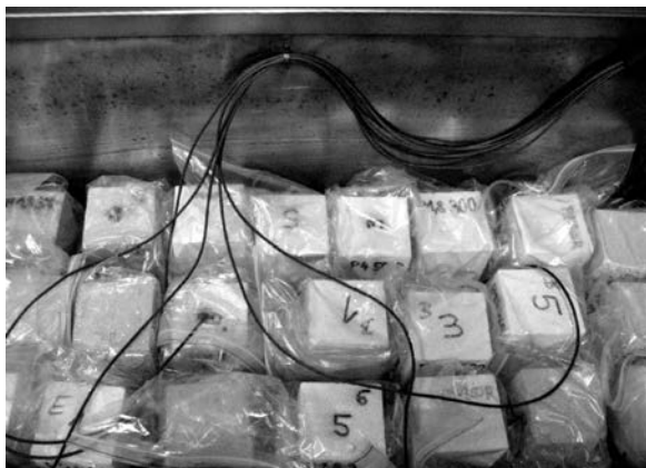
Obr. 1. Zkušební tělesa uložená v zmrazovacím boxu
