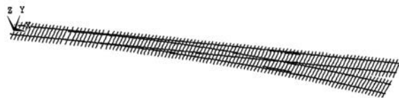
Obr. 5. Prutový trojrozměrný model výhybky pro výpočet v programu Ansys
