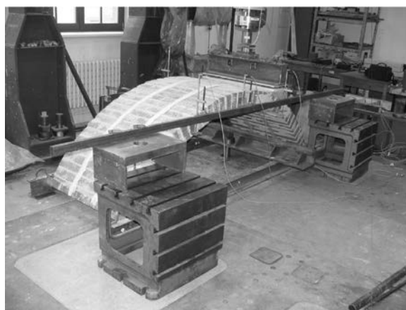
Obr. 6. Klenba ukotvená k podlaze haly pod zatěžovacím rámem
