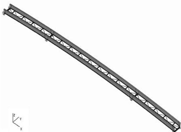
Obr. 6. Tvar konstrukce lávky
