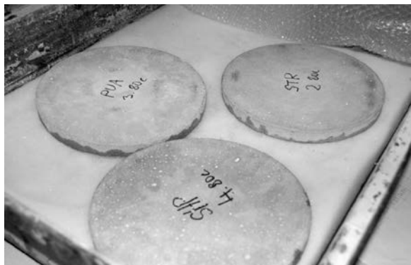
Obr. 11. Talířové vzorky pro zkoušku povrchové nasákavosti (dle UNI 10859)
