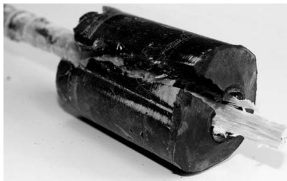
Obr. 2. Příčné roztržení kotevního válečku
