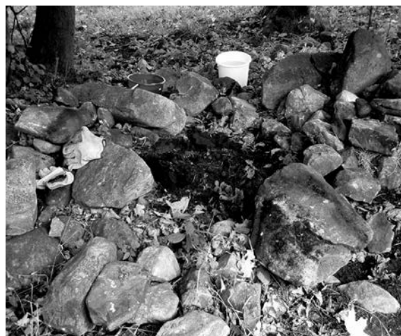
Obr. 3. Úprava povrchu před osazením soustředných válců pro terénní infiltrační měření (oblast 1 – val 1)
