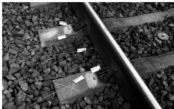
Obr. 3. Rozmístění snímačů na vnějším kolejnicovém pásu v oblouku – kampaň Napajedla; upevnění Pandrol FC I
