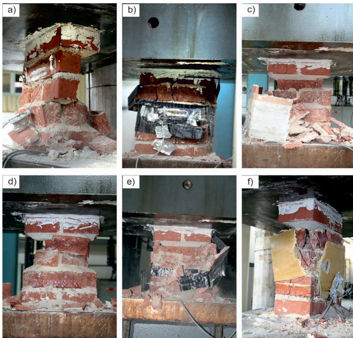
Obr. 9. Porušení zděných pilířů při dosažení mezního zatížení dostředným tlaku a) nezesílený pilířek, b) zesílený tkaninou z uhlíkových vláken, c) zesílený tkaninou ze skelných vláken, d) zesílený tkaninou z aramidových vláken
