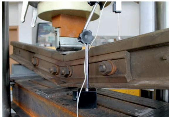
Obr. 3. Laboratorní měření kolejnice a spojky
