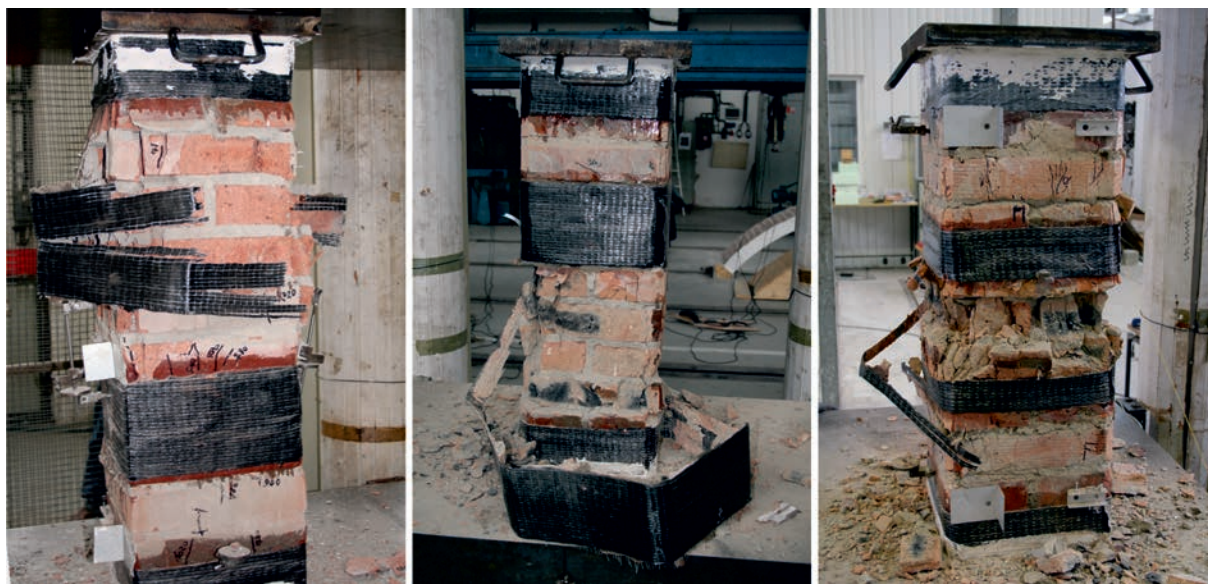
Obr. 1. Dosažení mezního zatížení N_{u,m} zděných pilířů vyztužených pásy z tkaniny z uhlíkových vláken – charakteristické náhlé přetržení tkaniny ve střední třetině výšky pilíře provázené úplným rozrušením zdiva pilíře
