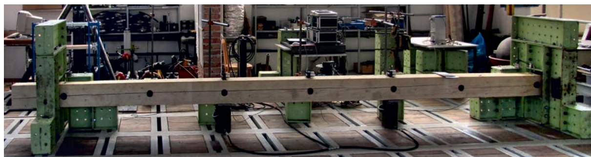
Obr. 2. Uspořádání čtyřbodové ohybové zkoušky – trám bez spoje
