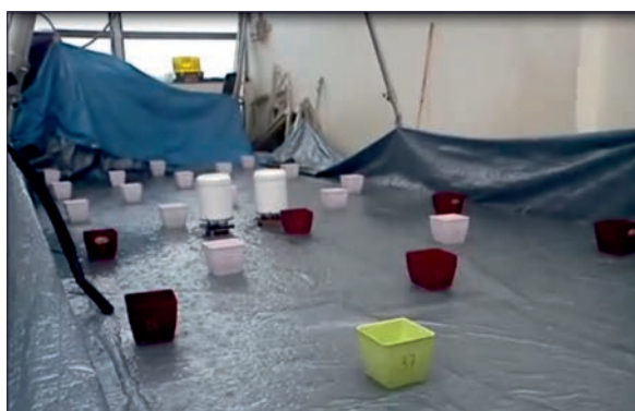
Obr. 2. Síť odměrných nádob na celé zadešťované ploše
