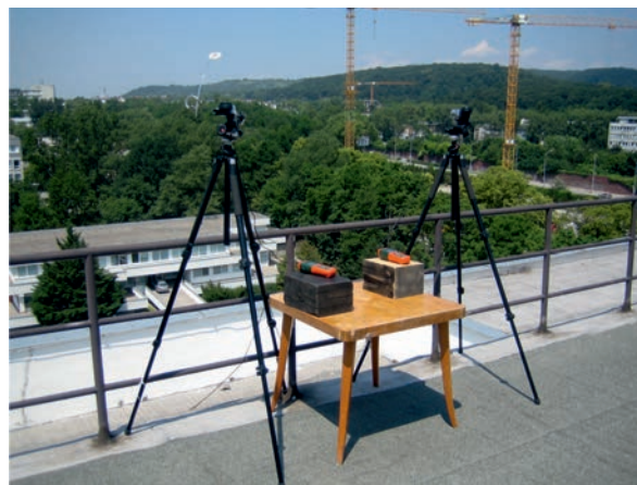
Obr. 1. Luxmetry se senzory měřící horizontální globální a difúzní osvětlenost
