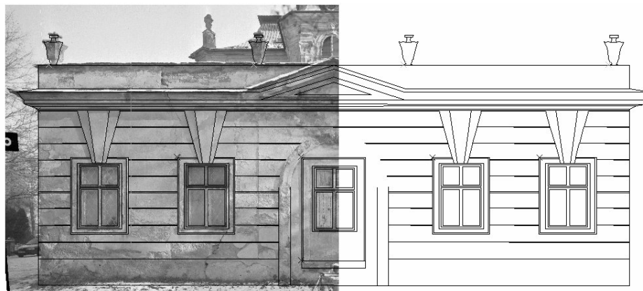
Obrázek 1-8: výsledný fotoplán a vektorové vyhodnocení fasády
