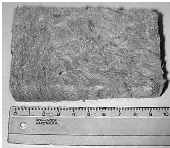
Obr. 1. Hydrofilní minerální vlna DD v průřezu, tvrdá vrstva DDH vlevo, měkká vrstva DDS vpravo
