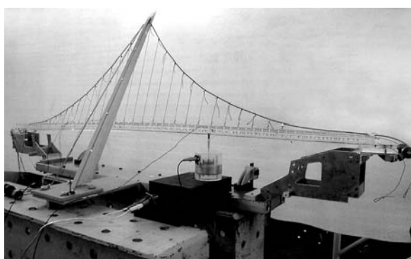
Obr. 14. Aeroelastický model lávky v San Diegu, délkové měřítko 1 : 70 (Stráský, Hustý a partneři, s. r. o.)
