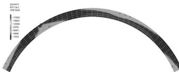
Obr. 8. První hlavní napětí při dosažení mezího zatížení
