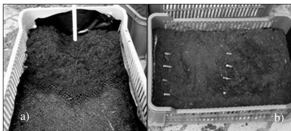
Obr. 4. Zkušební výsadba vrbových řízků (zemina, geosít, zemina, vrbové řízky Salix fluviatilis , Salix purpurea , Salix triandra )
