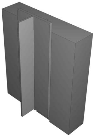
Obr. 5. Model poloviny protlačovacího vzorku
