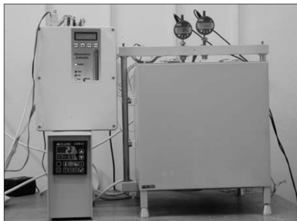
Obr. 3. Pec pro měření teplotní délkové roztažnosti
