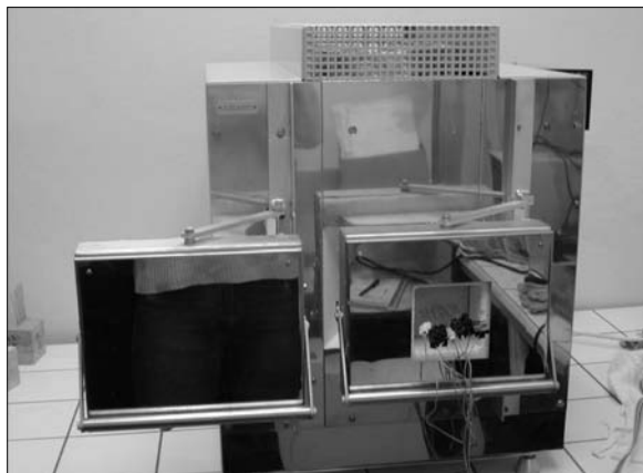
Obr. 1. Pec pro měření součinitele teplotní vodivosti
