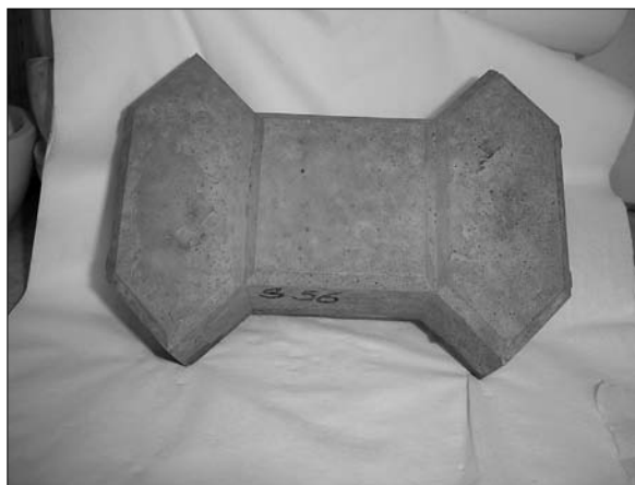
Obr. 8. Vzorek zámkové dlažby vyrobené z geopolymerního betonu
