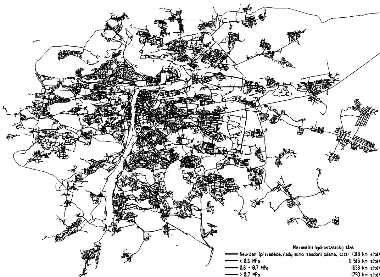
Obr. 5. Přehled maximálního hydrostatického tlaku ve vodovodní síti
