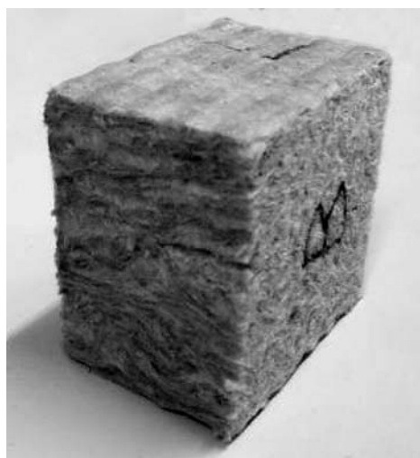
Obr. 3. Materiál PRG s vlákny kolmými na stranu B
