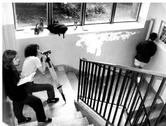
Obr. 2. Určování svislých posunů pomocí nivelace
