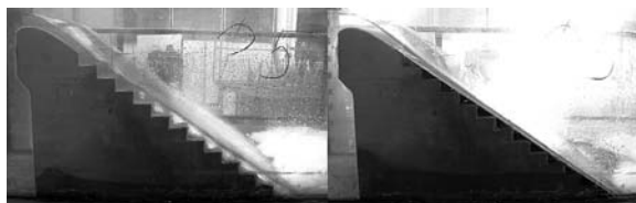
Obr. 3. Variant skluzu se sklonem 1 : 1,5 (stupňovitý a hladký)
