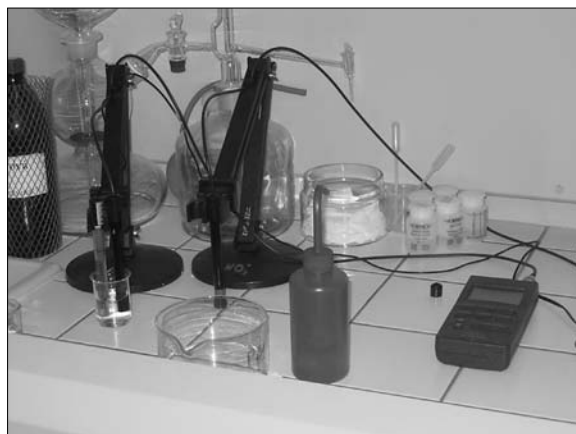
Obr. 1. Přístroj pH/ION 340i s iontově selektivní elektrodou
