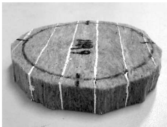
Obr. 4. Materiál DDH90 – vlákna rovnoběžná se směrem difúzního toku
