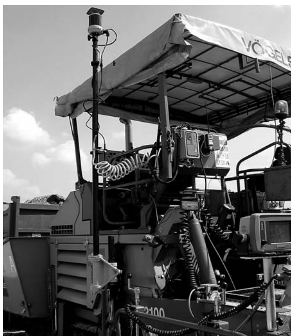
Obr. 4. Nivelační systém mmGPS umístěný na finišeru Voegle 2100
