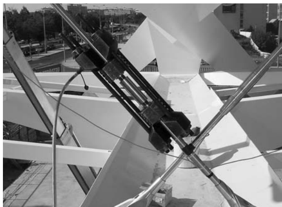
Obr. 8. Technotensioner osazený na táhle
