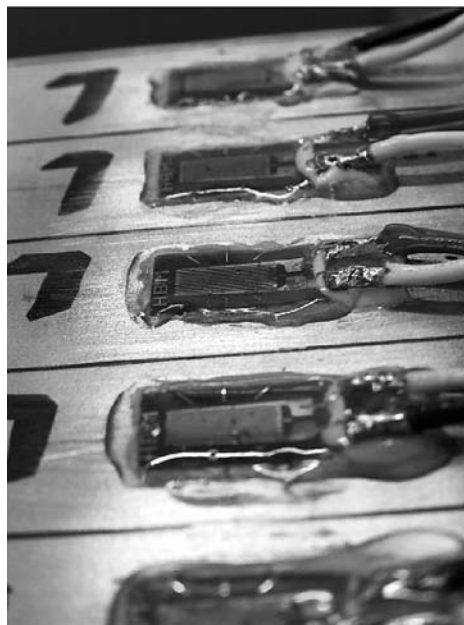
Obr. 5. Tenzometry opatřené krycím silikonem
