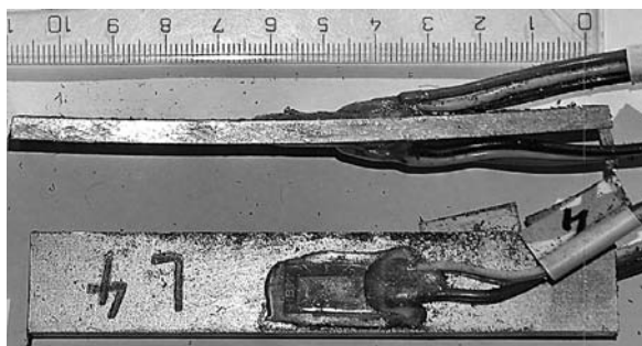
Obr. 8. Proužky po uvolnění podélných pnutí, vzorek č. 1 profilu 120x120x4 mm
