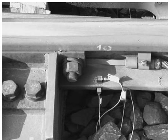
Obr. 1. Umístění snímačů zrychlení na křídlové kolejnici
