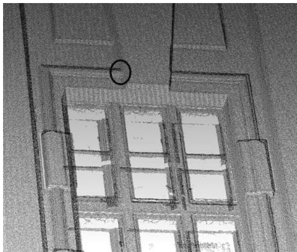
Obr. 3. Mračno bodů s průměrným rozestupem 2 mm
