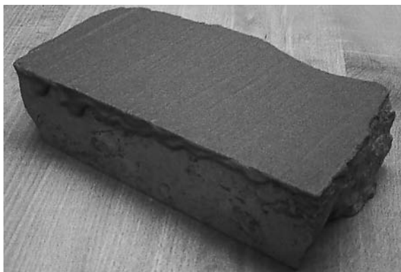
Obr. 1. Vzorek opuky s aplikovaným krystalizačním nátěrem
