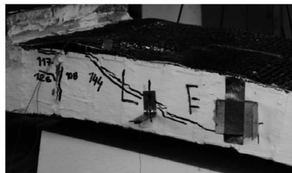
Obr. 7. a) příklad uspořádání kotevních oblastí uhlíkové tkaniny (CFRP) umístění na rubu a líci klenby; b) smykové porušení klenby v oblasti kotvení uhlíkové tkaniny
