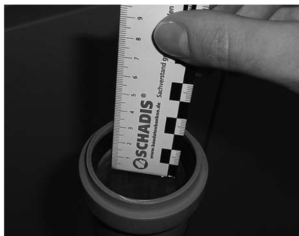
Obr. 3. Měření úbytku kapaliny během zatěžování
