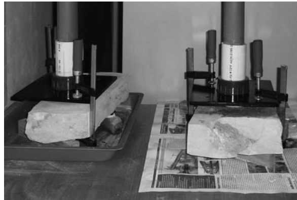
Obr. 2. Vzorek zatžený vodním tlakem
