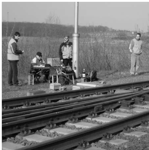
Obr. 3. Měřicí stanoviště u výhybky s pohyblivým hrotem srdcovky
