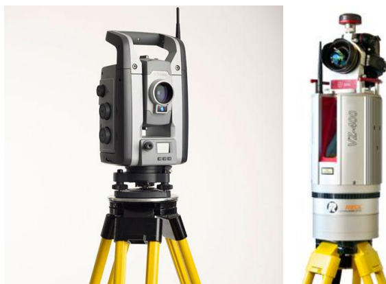
Obr. 8 Trimble VX (vľavo) a Riegl VZ-400 (vpravo)
