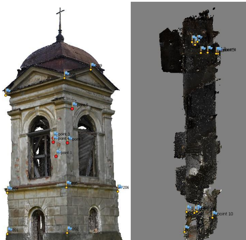
Obr. 9 Rozloženie vlčovacích a spojovacích bodov
