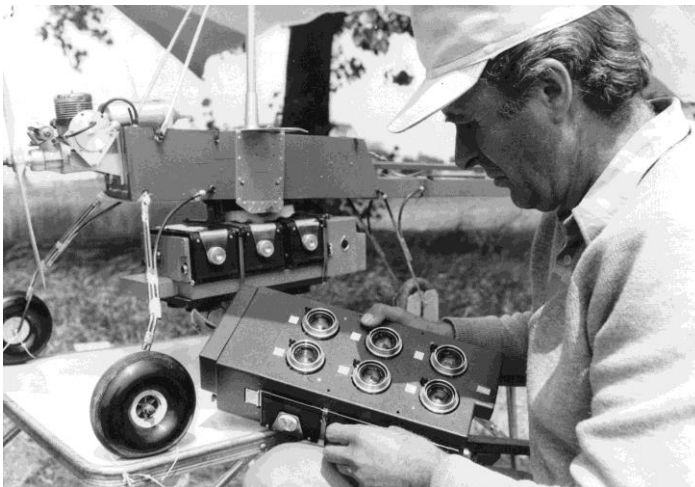
Obr. 7 Multispektrální kamera Flexaret M-6 – otevřená (vlevo) a umístěná na modelu „Rogallo 1981“, resp. v rukou J.Trnky (vpravo) – archiv autora
