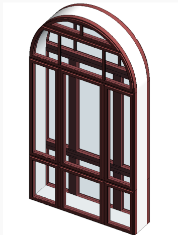
Obrázek: Finální komponenta - dvojitě klenuté špaletové okno
