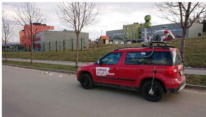
Obr. 1: MMS Riegl VMX-450 v popředí Výzkumného centra AdMaS
