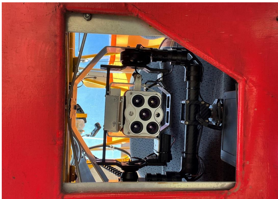
Obrázek 4. Upravený gimbal pro MicaSense Altum na TL-232 Condor – pohled na trup letadla, zdroj dat: vlastní
