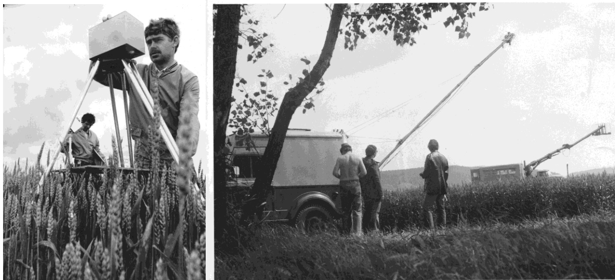
Obrázek 7: Zjišťování spektrálních koeficientů odrazu v průběhu experimentu „AN-30/1982“ pomocí československého spektrometru SMZ-1B (vlevo) a pomocí spektrometrů ZIPE (vpravo v popředí) a PS-3 „Kaspj“ (vpravo v pozadí).
