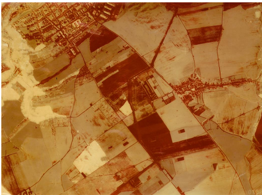
Obrázek 6: Mixáž na MSP-4C (IKI Baku) s využitím originálních negativů scény č. 394 kamery MKF 6M z výzkumné plochy Střítež (ilustrativní příklad). Pro spektrální pásmo 4 byl zvolen zelený filtr (potenciometr na hodnotě 9) pro spektrální pásmo 5 žlutý filtr (potenciometr na hodnotě 5) a pro spektrální pásmo 6 filtr červený (potenciometr na hodnotě 8)
