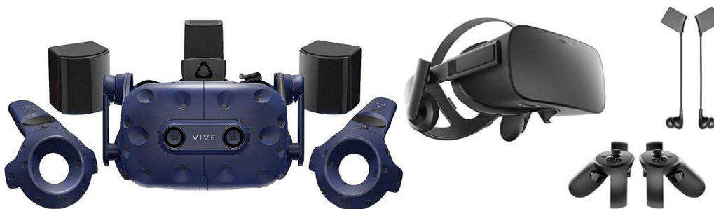
Obr. 4 – Brýle pro VR (vlevo HTC Vive Pro, vpravo Oculus Rift)
