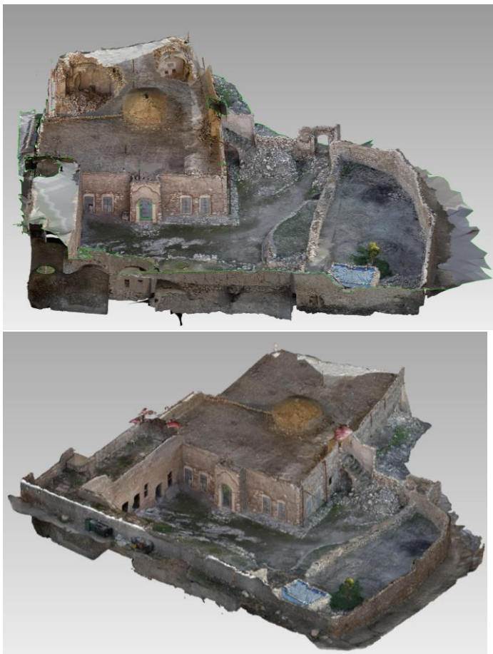
Obr. 4 – Modely hrobky Nahuma (vlevo – původní stav, zhroutilé zdi a střecha, vpravo doplněný model o zničené části).
