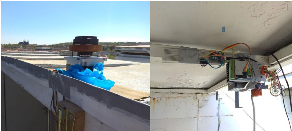
Obr 2 Testování fázového centra antény
