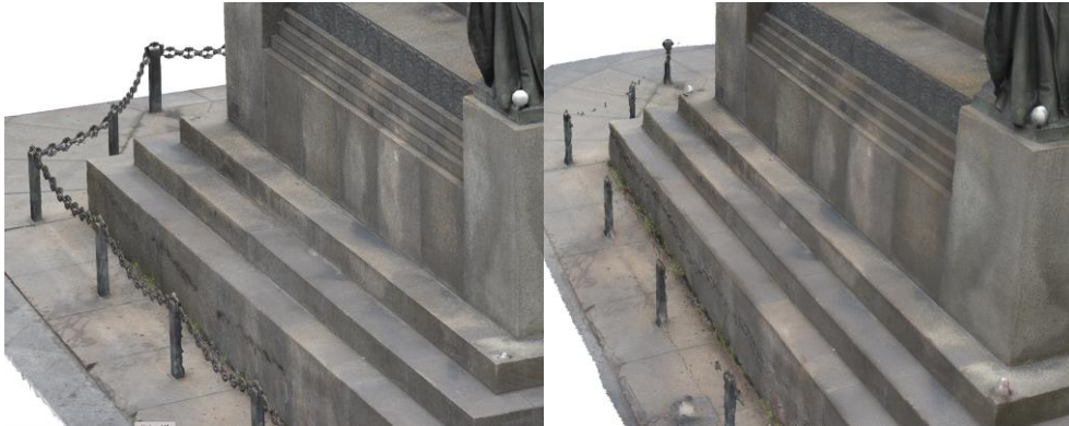
Obr. 1: Ukázka výsledného modelu (pomník sv. Václava na Václavském náměstí v Praze) – vlevo kombinace fotografií a dat z laserového skeneru, vpravo pouze model z fotografií
